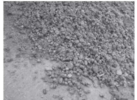
写真-3 礫状の掘削ズリ
