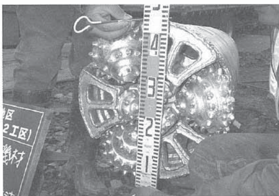
写真-3 ロックマンエース推進機φ400
